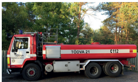
Paakauto Volvo pärineb aastast 1990 ning mahutab 10 000 liitrit vett ja 500 liitrit vahtu. Fotod MTÜ Tõdva Pääste
