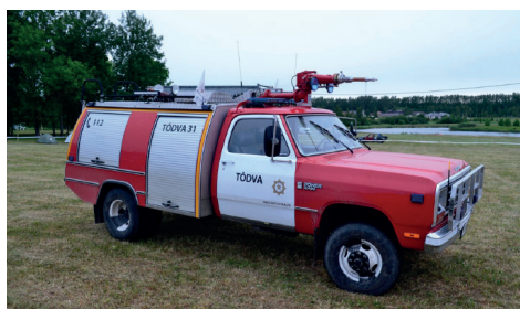
Tõdva tulekustutusauto Dodge pärineb aastast 1985 ning mahutab 1000 liitrit märga vett ehk vee ja vahu segu.
